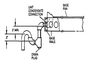
FIGURE 4 - RECOMMENDED DRAIN PIPING
